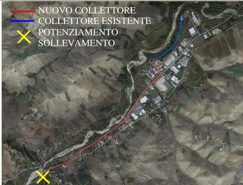
Figura 4-1 - Interventi sul collettore fognario a monte dell'impianto di depurazione
