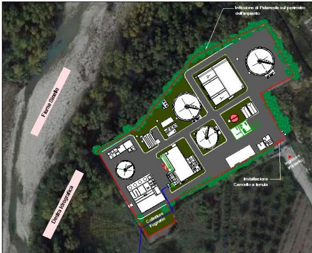
Figura 2-6 – Ubicazione opere di difesa fluviale con ridefinizione della sistemazione a verde dell'area.
